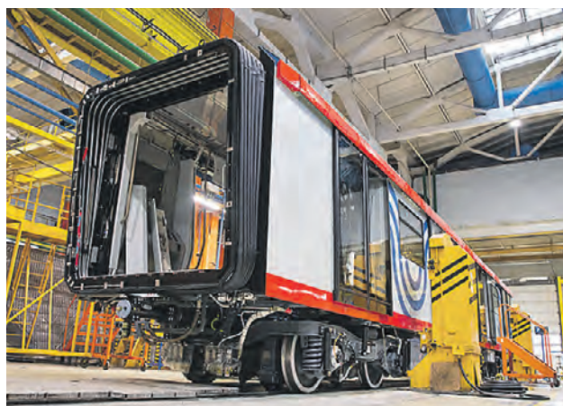
25 октября. Вагон нового состава «Москва-2026» на сборке на заводе в подмосковных Мытищах
